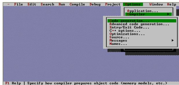
Fig. 2.1.- Configuración de los modelos de memoria.
